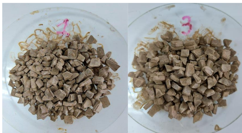
Hình 4. Ảnh mùn khoan sau 24 giờ xử lý bằng dung dịch Hib-X (trái) và PEDA-258 (phải) – Kết quả thí nghiệm tại XN Khoan & Sửa giếng Vietsovpetro.
